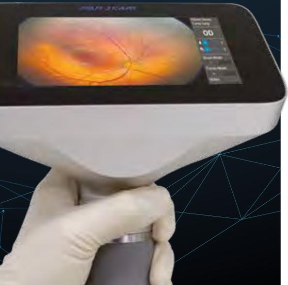
La pièce à main permettant l'acquisition d'image n'est pas directement reliée à la console du PanoCam. Il est de ce fait très facile de l'utiliser sur plusieurs sites ou plusieurs salles d'opération.
